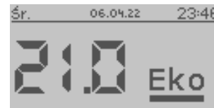
Abb. 28 STANDARD Sollwertgeber – Hauptmaske (Wahl des Betriebsmodus)
