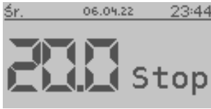
Abb. 23 STANDARD-Sollwertgeber – aktiver STOP Modus
