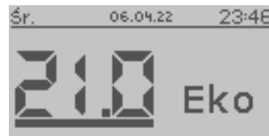
Rys. nr 27 Zadajnik STANDARD – ekran główny (zadawanie temperatury)
