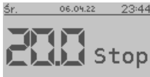
Rys. nr 23 Zadajnik STANDARD – aktywny tryb STOP
