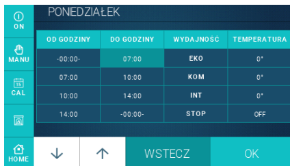
Rys. nr 37 Ustawianie kalendarza zadajnika ADVANCE
