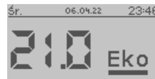
Rys. nr 28 Zadajnik STANDARD – ekran główny (wybór trybu pracy)
