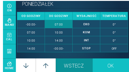
Abb. 37 Einstellung des Kalenders des ADVANCE Sollwertgebers
