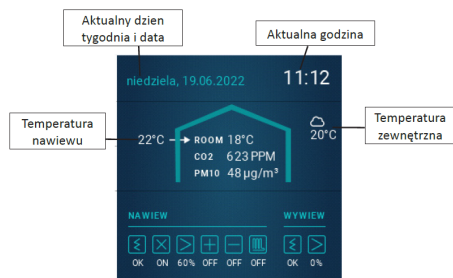
Rys. nr 33 Opis głównego ekranu zadajnika ADVANCE
