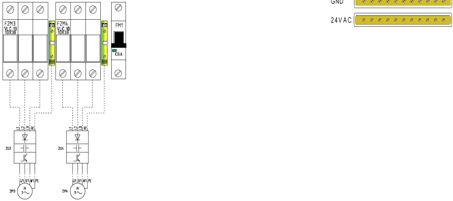
Rys. Nr 58B Schemat zasilania dla falowników z zasilaniem 3 fazowym 3×400VAC (osiem wentylatorów do 11kW)
