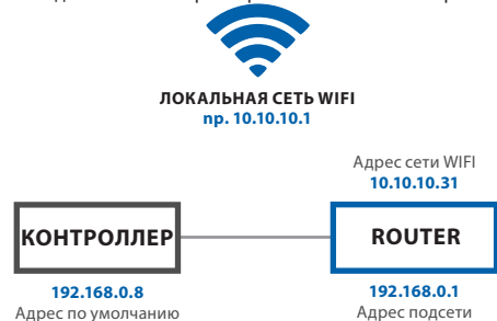
Рис. 30 Подключение контроллера к локальной сети по Wi-Fi
