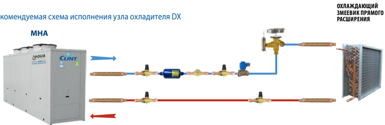
Рис. №36 Подключение охладителей DX (прямое испарение)
