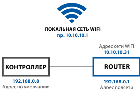
Рис. 15 Подключение контроллера к локальной сети через WiFi
